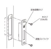
算のかかり具合と、戸~枠間の隙間を隙間調整ネジで調整してください。
