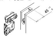
上吊戸車II からケーシングを外し、扉の上部に加工したU字溝に3本のネジでケーシングを取付けてください。
