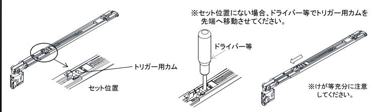
レールの向き、製品の向きに注意し、下図の様にレール内に製品と上吊戸車 II を挿入しレールを上枠に付属のレール取付ネジで固定してください。
