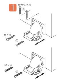
床と扉金具のスキマが7mm±2mmになるように高さを調整してからビス①で固定してください(左下図
