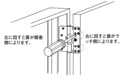
固定ネジ2箇所 (A) をゆるめてから①の左右調整ネジにて調整して下さい。調整後は必ず固定ネジ2箇所 (A) を締めてください。
